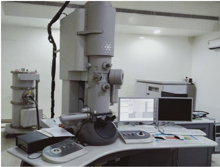
Fig. 2.11. TEM system used for the work (FEI Tecnai G2-STWIN TEM).
